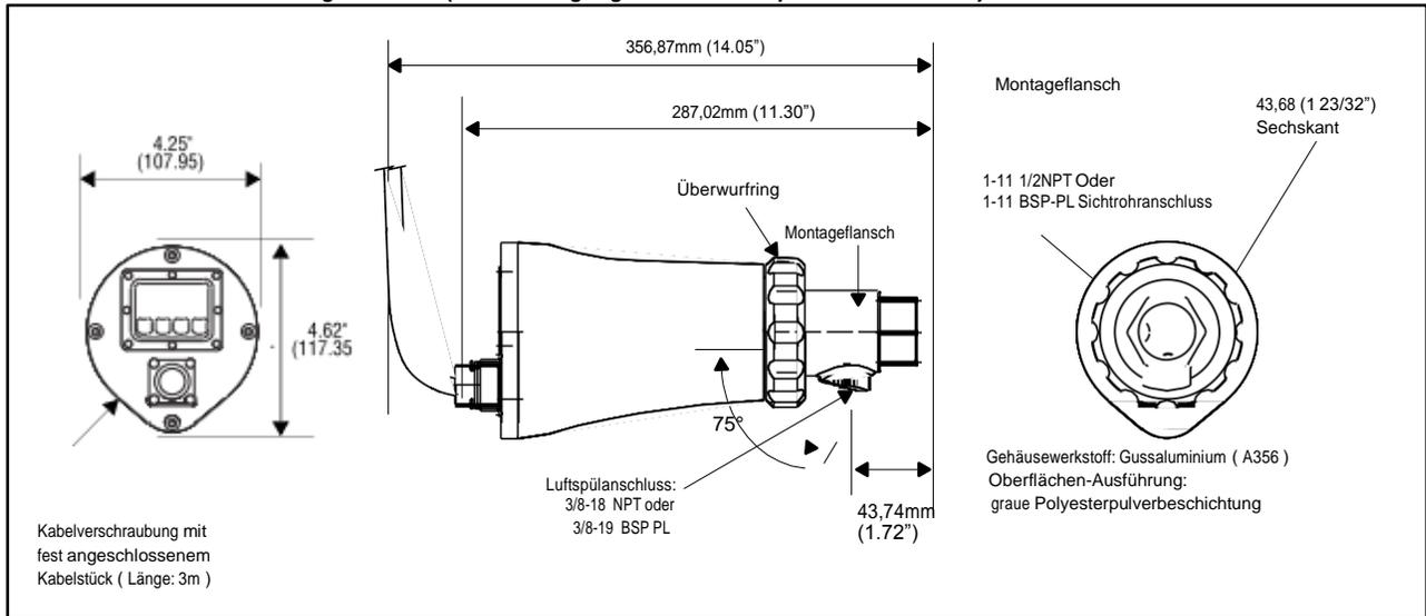
**Bild 3. Flammenfühler Typ 95IR/95UV/95DS eingebaut in einem CENELEC EExd - Gehäuse (der Befestigungsflansch ist separat zu bestellen )**
