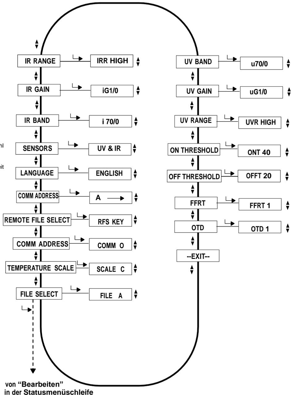
Anm. 1: Hier ist das Menü Bearbeiten für das Zwei-Sensor-Modell (DS-Modell) dargestellt. Bei Flammenfühlermodellen mit nur einem Sensor (IR oder UV) wird nur der betreffende Parameter angezeigt, z. B. Sensor (Sensor), Band (Frequenzband), Gain (Verstärkung), Range (Bereich).
