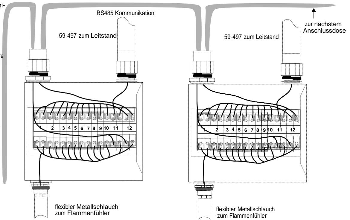
**Bild 20.** Verdrahtungsplan für die Anschlussdose
