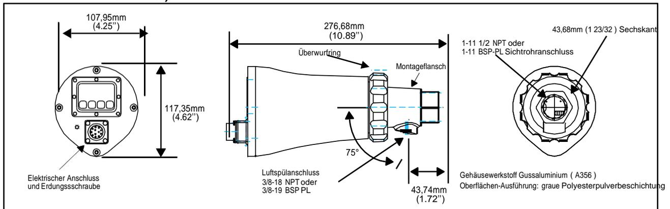
**Bild 2. Flammenfühler Typ 95IR/95UV/95DS, "CG" - Modell mit Kabelverschraubung und fest angeschlossenem 3m langem Kabel (der Befestigungsflansch ist separat zu bestellen )**
