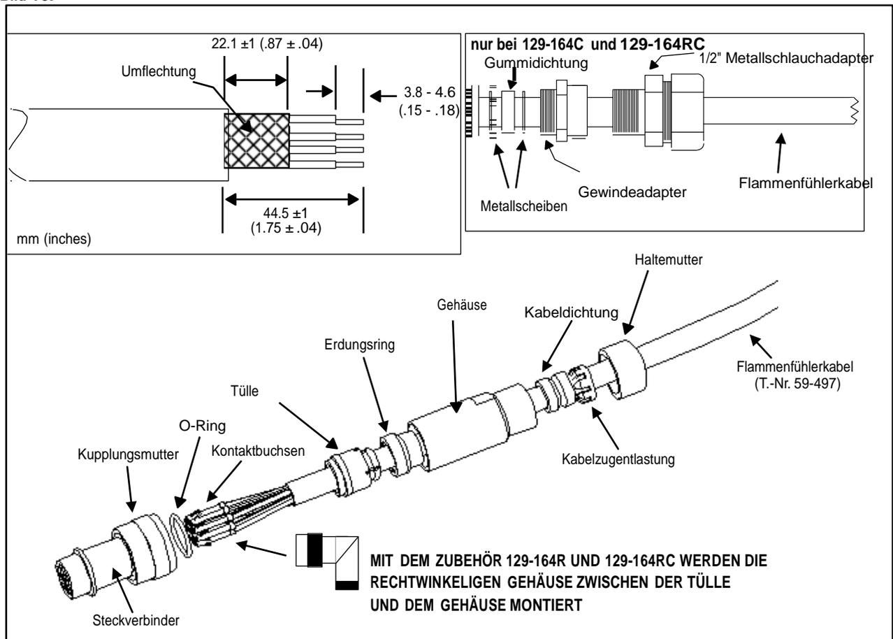
**Schnellkupplungsbuchse - Zusammenbauanleitung**
