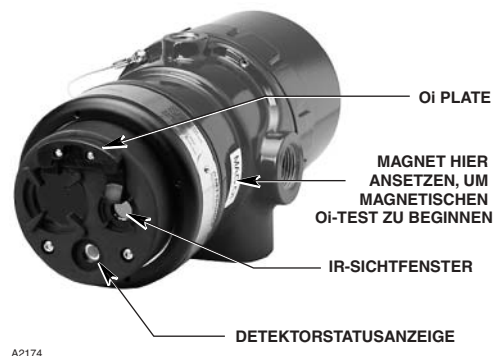
Abb. 2—Vorderansicht des X9800
