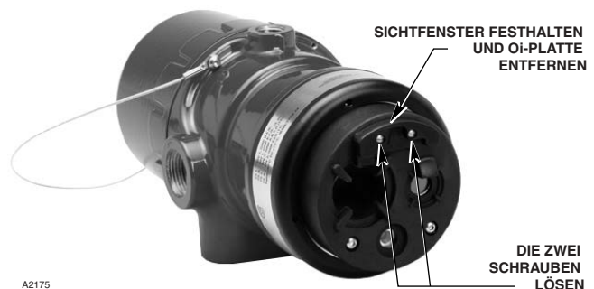
Abbildung 13—Entfernen der Oi-Platte
