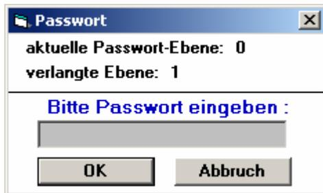
Nach Betätigung der Schaltfläche „Melder-Service“ (und gegebenenfalls Eingabe eines Passwortes) wird die Brandmeldezentrale deaktiviert. Sie erfasst die Melderzustände nicht mehr. Eine Alarm- oder Störungsausgabe durch die BMZ erfolgt daher ebenfalls nicht. Sofern die Zentralsoftware bezüglich abzufragender Geräte korrekt konfiguriert ist (s. Abschnitt Geräte Eing.), wird ein Alarm- oder Störungszustand durch die Sammelanzeige der Zentralsoftware signalisiert.
