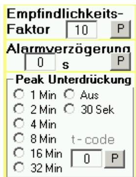
Für beide Auswertesätze (Satz 1 und Satz2) individuell lässt sich ein globaler Empfindlichkeitsfaktor einstellen. Bei „10“ (entsprechend „1,0“) gelten die Schwellen genau wie angegeben. Bei kleineren Empfindlichkeitsfaktoren werden stattdessen höhere Schwellen (z. B. bei EF = 5 entsprechend „0,5“ werden die doppelten Schwellen, bei EF = 20 entsprechend „2,0“ werden die halben Schwellen) angesetzt.
