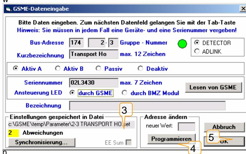
er gelb hinterlegten Zahl (3) der Abweichungen angezeigt; Mit dem Button (4) „Synchronisierung...“ können die Einstellungen des alten Melders in den neuen übertragen werden.
