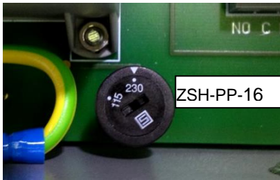
Bild 5: Rastschalter für Umschaltung der Versorgungsspannung
