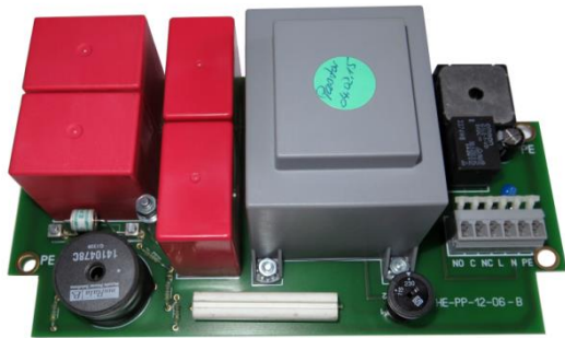
Bild 10: ZSH-CRD: Komplett bestückte Ersatzleiterplatte
