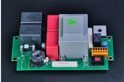
Bild 11: ZSH-GDT: Gasentladediode
