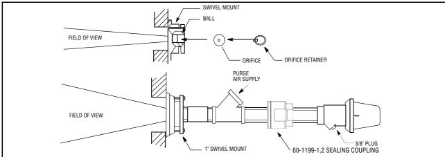
FIGURE 16. SCANNER WITH ORIFICE
