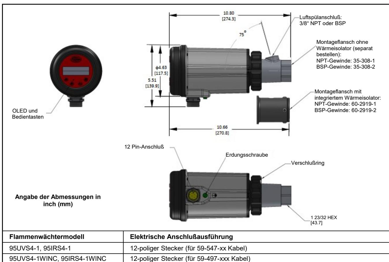
Bild 2: Abmessung 95UVS4-1CEX, 95UVS4-2CEX, 95IRS4-1CEX, 95IRS4-2CEX
