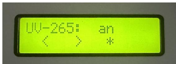
Abbildung 4 – Zuschalten der 265 nm UV-LED
